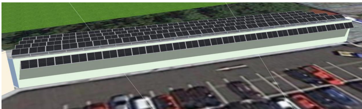
Obrázek 11: Budova Dvůr SEVER I, parcelní číslo 1281/2. Moduly umístěné na konstrukci se sklonem 30^\circ , orientace J 189^\circ doplněné o řadu modulů se sklonem 50^\circ - přesah přes vjezd.
