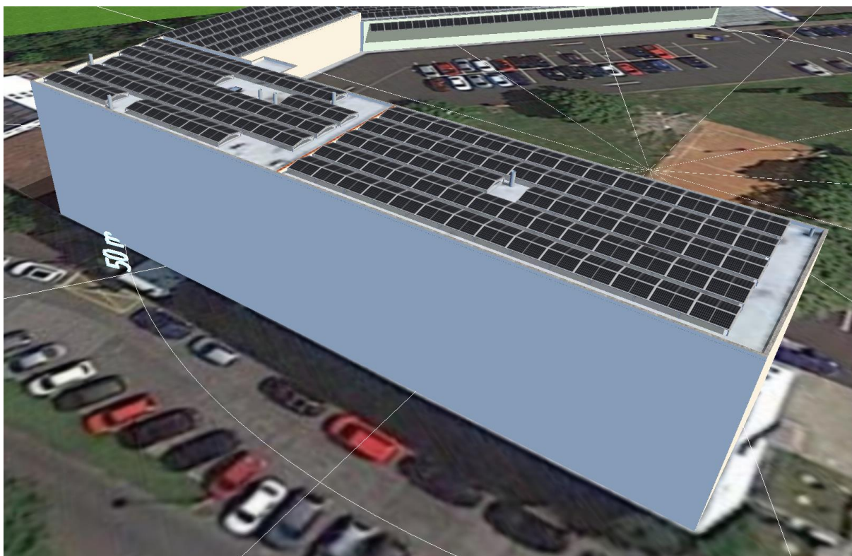
Obrázek 9: Budova A, č.p. 4219, parcela č. 1280. Moduly umístěné na konstrukci typu V-Z se sklonem 10^\circ .
