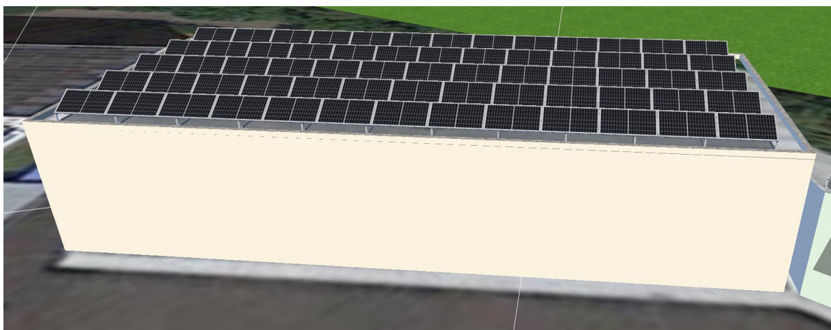
Obrázek 12: Budova Dvůr SEVER II, parcelní číslo 1281/11 a 1281/12. Moduly umístěné na konstrukci se sklonem 30^\circ , orientace JV 150^\circ .
